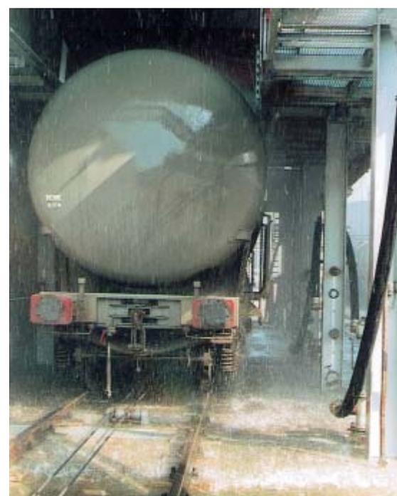
Abb. 3: Berieselung eines Benzin-Kesselwagens (ohne Schaumbeimischung).
