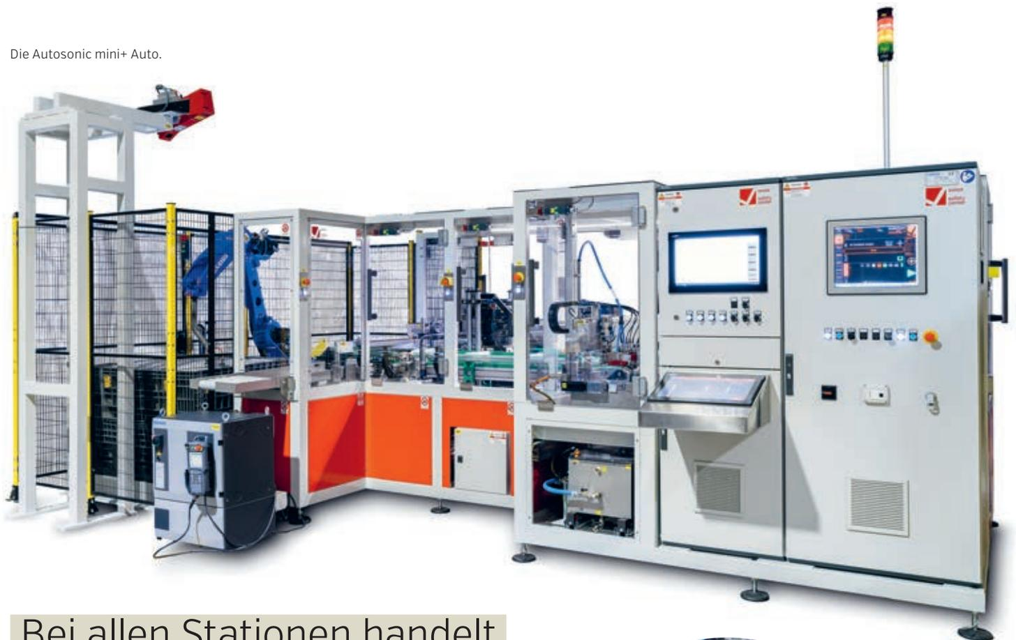
Bei allen Stationen handelt es sich um replizierbare Module, die sich einfach in verschiedene Anordnungen einbinden lassen und für Gasflaschen unterschiedlichster Art verwendbar sind.
